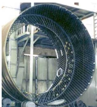
Рис. 3.28. Переходный отсек РН «Протон-М» с сетчатым шпангоутом
