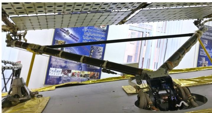
Рис. 3.49. Фотография крепления СБ к корпусу КА «Глонасс-К»
