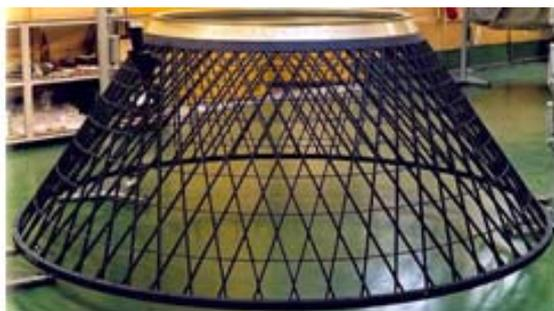
Рис. 3.27. Сетчатый композитный адаптер полезной нагрузки РН «Протон-М»
