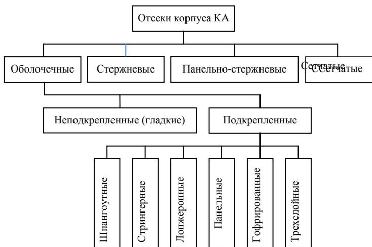
Рис. 3.1. Классификация отсеков корпуса КА по конструктивно-силовой схеме
