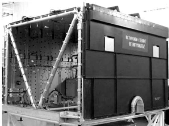
Рис. 3.21. Панельно-стержневой отсек КА-платформы «Ямал-100»
