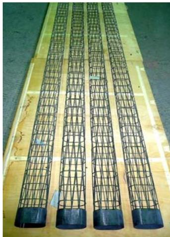
Рис. 3.29. Композитные сетчатые стержни
