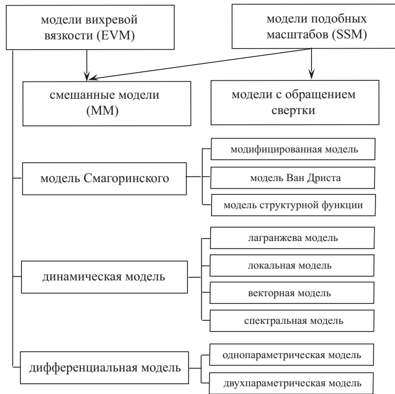
Рис. 3.1. Классификация моделей турбулентности подсеточного масштаба
