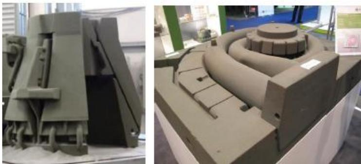
Рис. 2.7. Синтезированные песчаные формы (ExOne)
