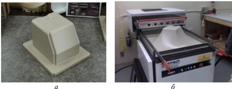
Рис. 4.27. Оснастка для вакуумного термоформования (а); процесс вакуумного термоформования (б)
