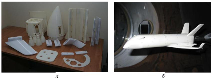
Рис. 4.54. Макет гиперзвукового ЛА: *а* – комплектующие макета, изготовленные с помощью 3D-технологий; *б* – макет в сборе
