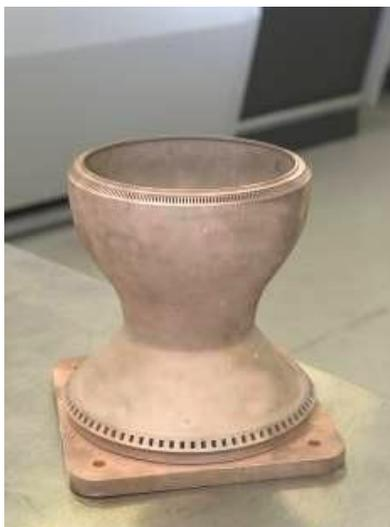
Рис. 4.47. Сопловая часть РД, полученная при помощи 3D-печати
