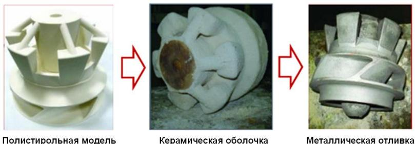
Рис. 4.12. Схема получения отливок с использованием полистирольных выжигаемых моделей
