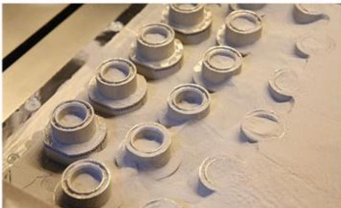
Рис. 4.38. Получение заготовок завихрителя камеры сгорания
