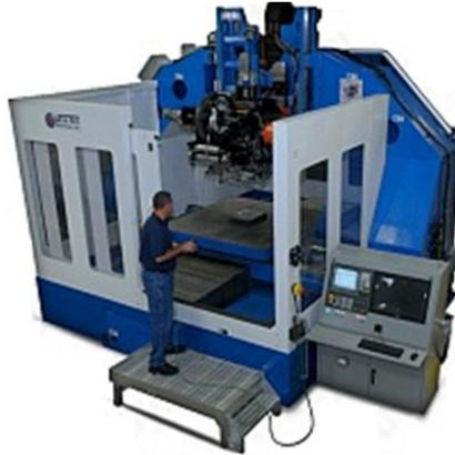
Рис. 3.29. 3D-принтер SonicLayer 7200
