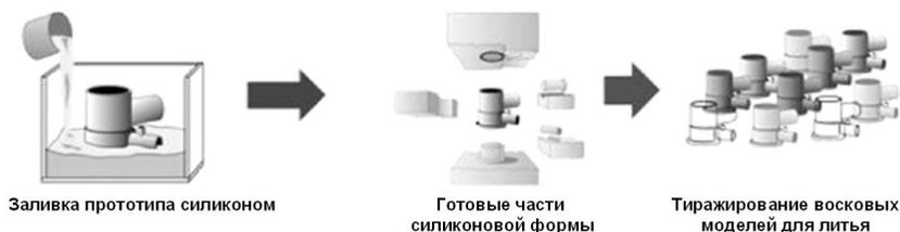
Рис. 4.14. Схема подготовки партии восковых моделей с использованием силиконовых форм
