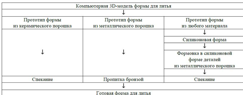
Рис. 4.18. Схемы технологий быстрого прототипирования при изготовлении форм для литья деталей из металла
