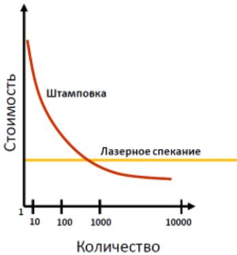
Рис. 4.10. Зависимости изменения себестоимости изготовления деталей методами штамповки и SLS от количества изготавливаемых деталей
