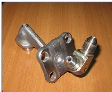
Рис. 4.39. Сварная и «выращенная» топливная форсунка
