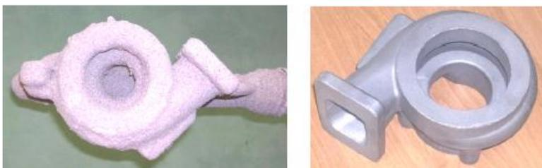
Рис. 2.17. Оболочковая форма и чугунная отливка корпуса турбины, полученные по восковой синтез-модели
