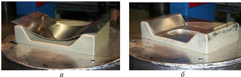
Рис. 4.21. Матрица пресс-формы, полученной с помощью аддитивных технологий: *а* – оснастка и листовой полуфабрикат; *б* – готовое изделие
