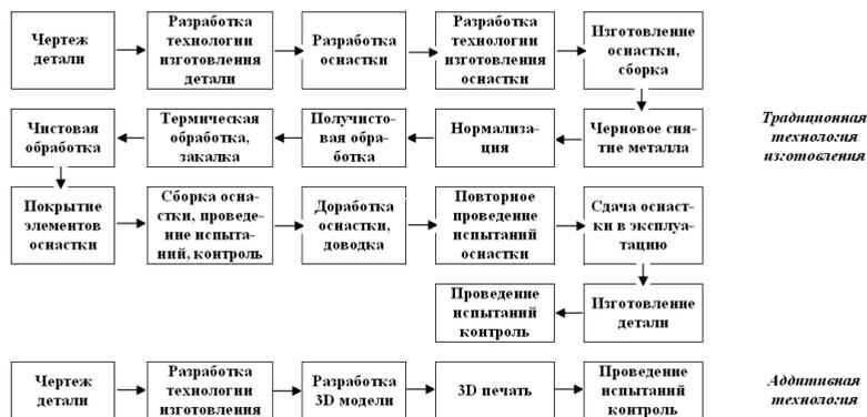
Рис. 1.2. Сравнение маршрутной технологии получения детали методами литья под давлением и по аддитивной технологии
