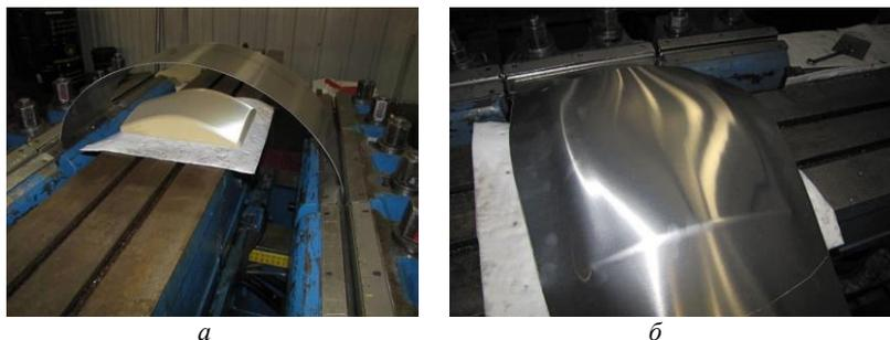
Рис. 4.25. Метод гибки с вытяжкой на оснастке, полученной на АФ-установках:
