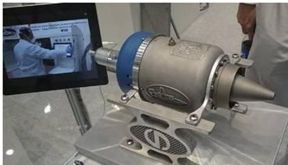
Рис. 4.45. Газотурбинный двигатель для БЛА, изготовленный по АФ-технологиям
