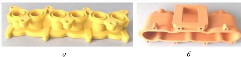
Рис. 2.4. Модели, полученные по технологии DLP:
