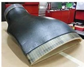
Рис. 4.28. Технологическая оснастка, полученная по технологии FDM, для выкладки композиционных материалов
