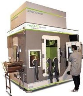
Рис. 3.25. 3D-принтер BeAM MAGIC
