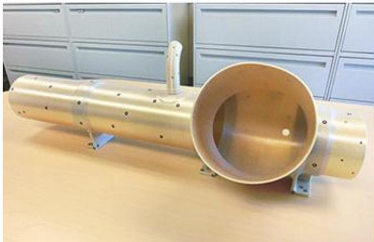
Рис. 4.48. Элемент системы кондиционирования воздуха усовершенствованной конструкции ракетносителей Atlas V и Delta IV, полученный по AF-технологиям
