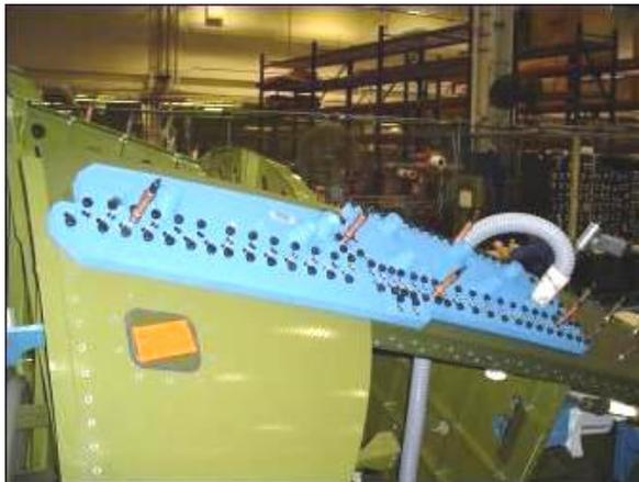
Рис. 4.24. Кондуктор для сверления отверстий в изделиях авиационной техники
