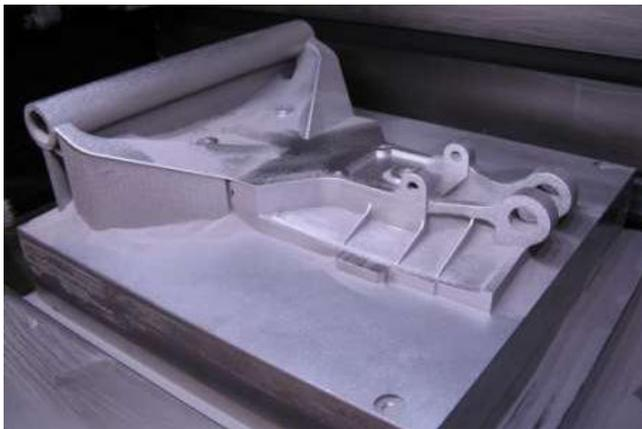
Рис. 4.40. Створка вертолетного двигателя
