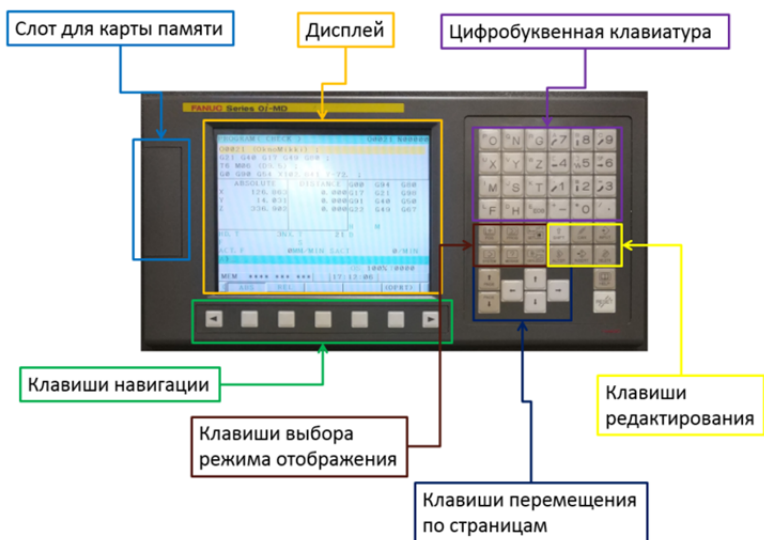
Рис. 20.2. Пульт системы ЧПУ Fanuc
