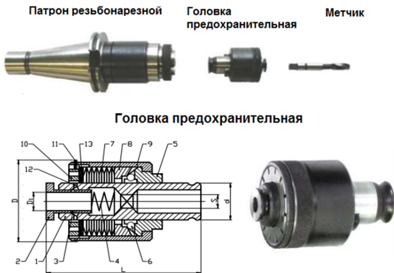
Рис. 15.6. Схема плавающего резьбонарезного патрона: 1 – корпус; 2 – втулка; 3, 6 – шарики; 4 – пружина; 5 – поводок; 7 – пружины тарельчатые; 8 – кольцо; 9 – гильза; 10 – гайка; 11 – кольцо замковое; 12 – заглушка; 13 – шайба
