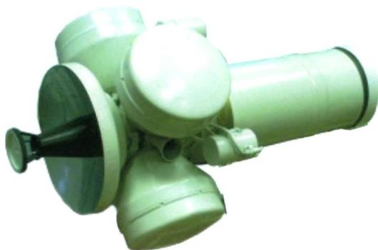
Рис. 11.7. Модель реактивного самонаводящегося снаряда-гироскопа для пилотируемого спутника-перехватчика
